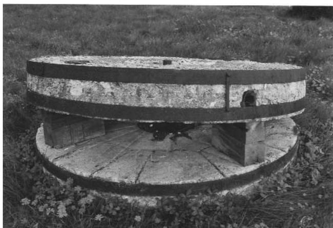
Il provient du « Moulin du bas » installé au bord de l'Ingressin à Toul et a été donné au musée par M. Humbert Patrick en 1997. Chacune de ces meules (dormante et tournante) a un diamètre de 150 cm pour une épaisseur de 22 cm. La meule tournante présente en son centre un « œil » circulaire de 33 cm de diamètre avec un axe en fer.
