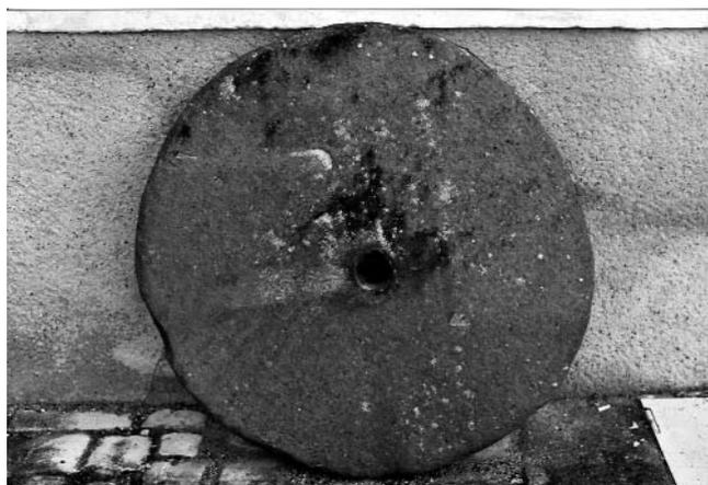
Cette meule a un diamètre de 96 cm pour une épaisseur de 12 cm sur les bords et 18 cm au centre. L'œil circulaire de 8 cm de diamètre contient du bois, du mortier et un axe en fer. La meule tournante avec laquelle elle fonctionnait a été placée dans la salle gallo-romaine du musée et provient d'une sablière de Dommartin-lès-Toul.
